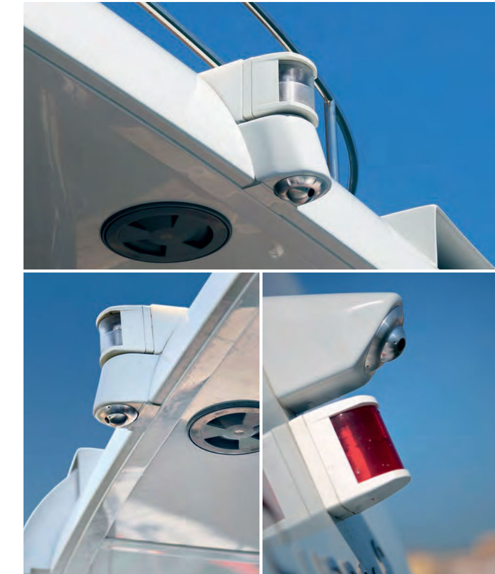
眼观六路：由铝制成的摄像头被安装在艏部、艉部和靠近航迹灯的位置。
