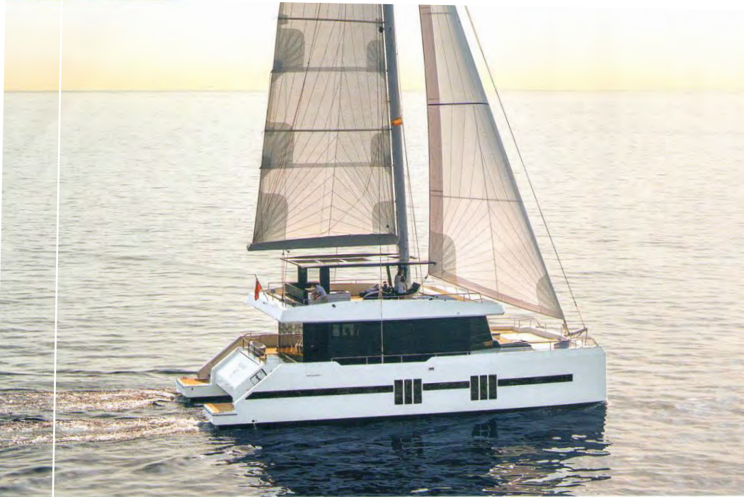
Ungewohnte Optik: Am Wind trägt die kantige Supreme 68 „Midori“ 232 Quadratmeter Hydra-Net-Laminat von Dimension-Polyant.
