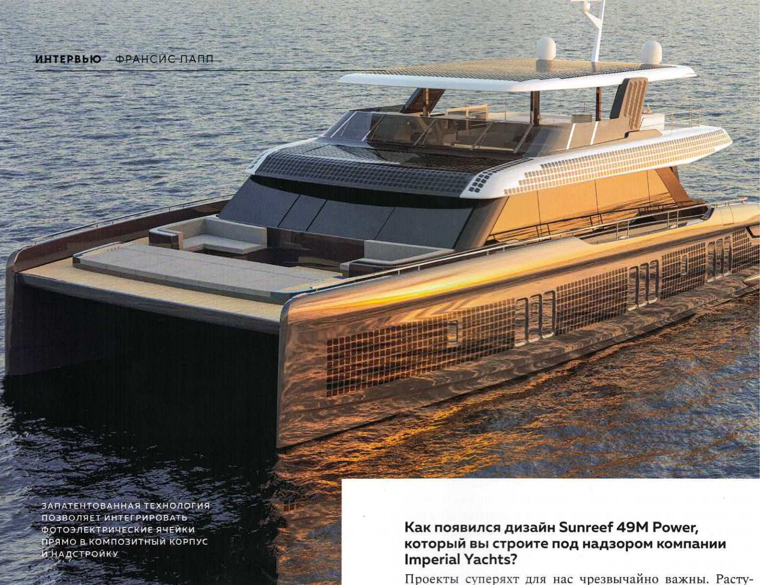
ЗАПАТЕНТОВАННАЯ ТЕХНОЛОГИЯ ПОЗВОЛЯЕТ ИНТЕГРИРОВАТЬ ФОТОЭЛЕКТРИЧЕСКИЕ ЯЧЕЙКИ ПРЯМО В КОМПОЗИТНЫЙ КОРПУС И НАДСТРОЙКУ
