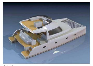
I dati: lungh. f.t. m 12,80; larghezza m 6,70; pescaggio m 0,65; dislocamento kg 6.800; motori 2 x 220 cv.
