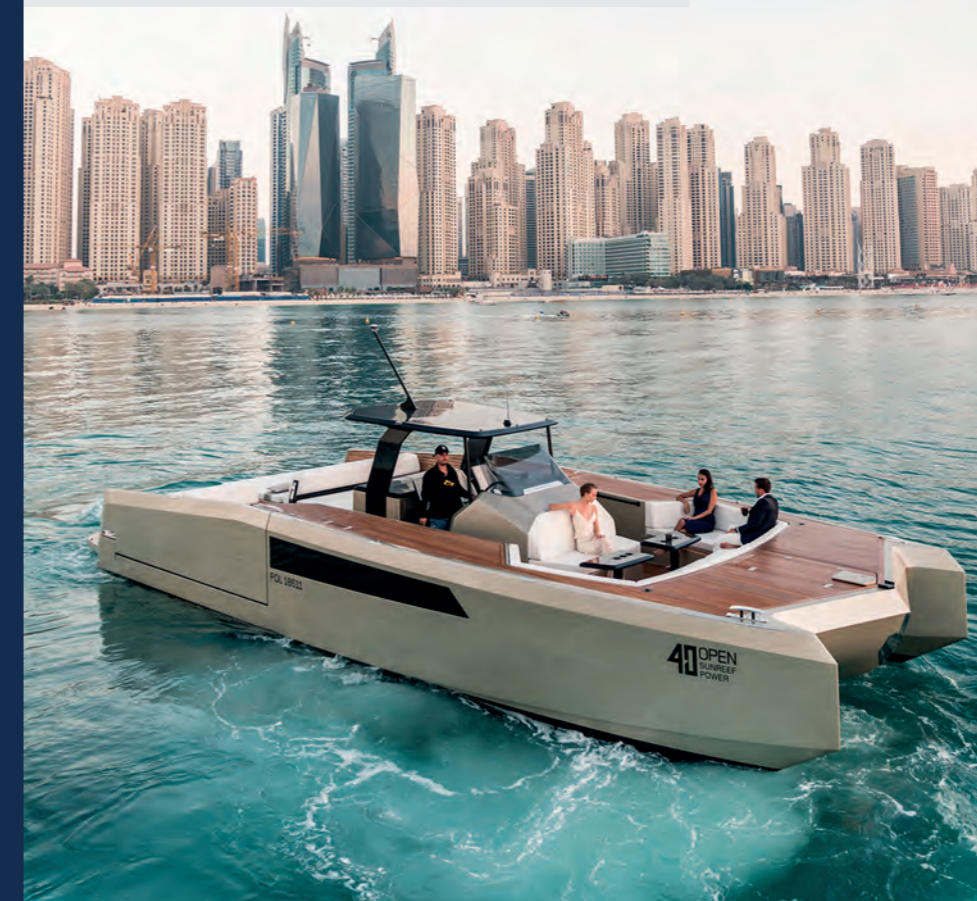
Верфь: Sunreef (Польша) Модель: 40 Open Sunreef Power Дизайн: Sunreef Yachts Материал корпуса: композитный материал Двигатели: 2 x 435 Hp | 2 x 860 Hp Максимальная скорость, узл.: 60 Длина, м/фут: 13.1 / 43'00" Ширина, м/фут: 5.2 / 17'10"
