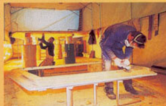
Atelier petites pièces en polyester: c'est ici que sont préparés les éléments tels que la casquette de roof.
