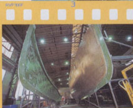
Le démoulage commence par les joues extérieures des coques alors que le moule central est encore en place.
