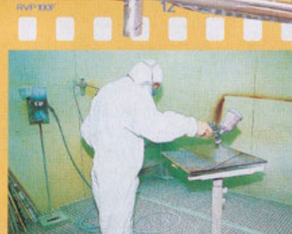
Le vernissage des meubles dans un atelier hors poussière est l'ultime opération avant leur installation sur le bateau.
