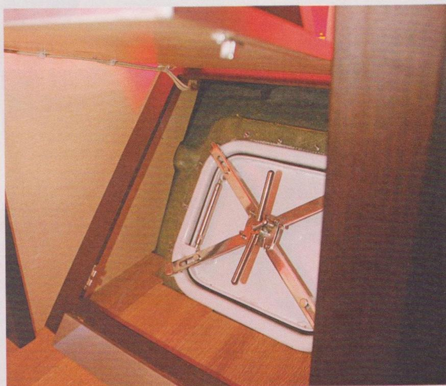
Um detalhe muito importante! Na remota eventualidade de o barco capotar, existem quatro saídas de emergência, como a que se pode ver na imagem e que asseguram a saída dos tripulantes e segurança.
