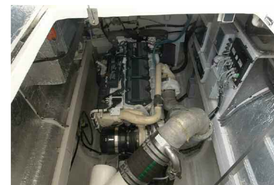
ハル後部にそれぞれエンジンとジェネレーターが設けられている。
