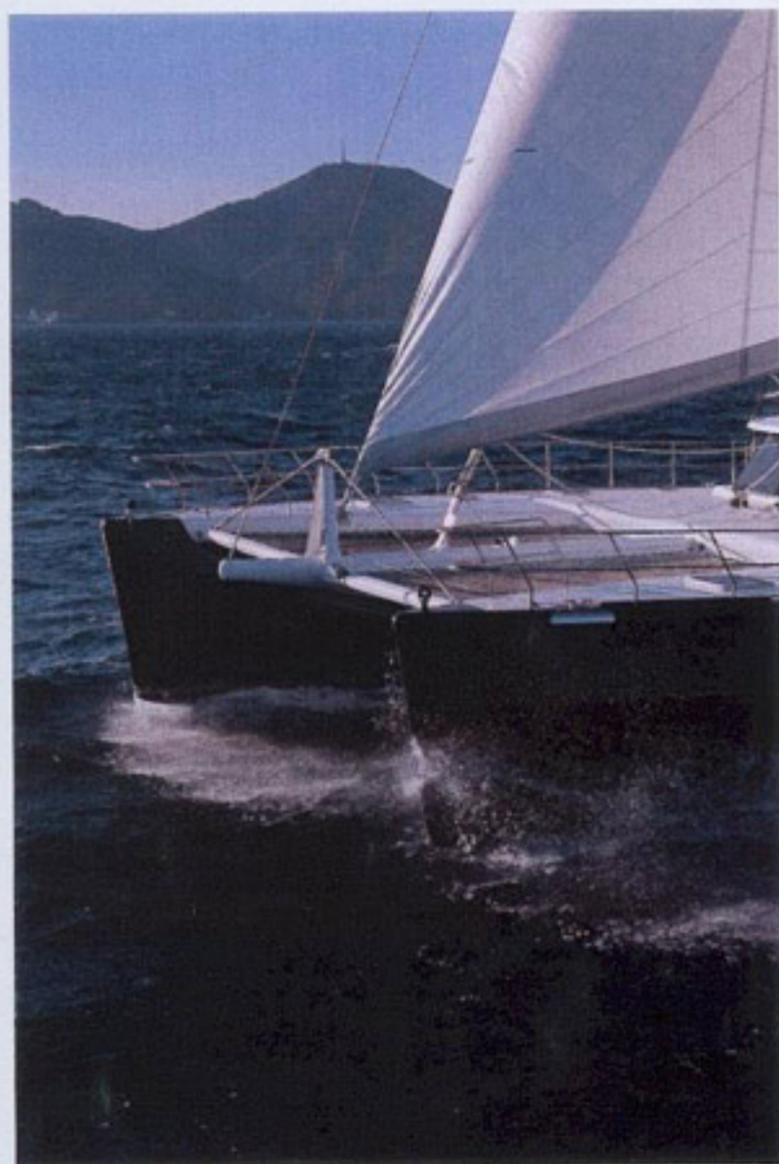
EN ACTION CES 44 TONNES DE DÉPLACEMENT FENDENT LES FLOTS SOUS 189 M<sup>2</sup> DE GRAND-VOILE LATTÉE ET 322 M<sup>2</sup> DE SPI (TOURMENTIN) AUTOUR D'UN MÂT DE 30 M, VOIRE À L'AIDE DE DEUX MOTEURS DE 240 CHEVAUX. AU MOUILLAGE, L'APPROCHE EST FACILITÉE PAR UN TIRANT D'EAU D'UNIQUEMENT 1,75 M.
